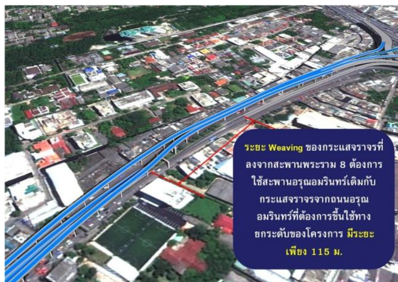
(ข) ระยะการตัดกันของกระแสจราจร (Weaving Section) บริเวณถนนอรุณอมรินทร์ ของรูปแบบ B1
