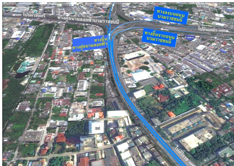
รูปที่ 1.3-3 รูปแบบทางขึ้น-ลง บนถนนอรุณอมรินทร์ รูปแบบ B3
