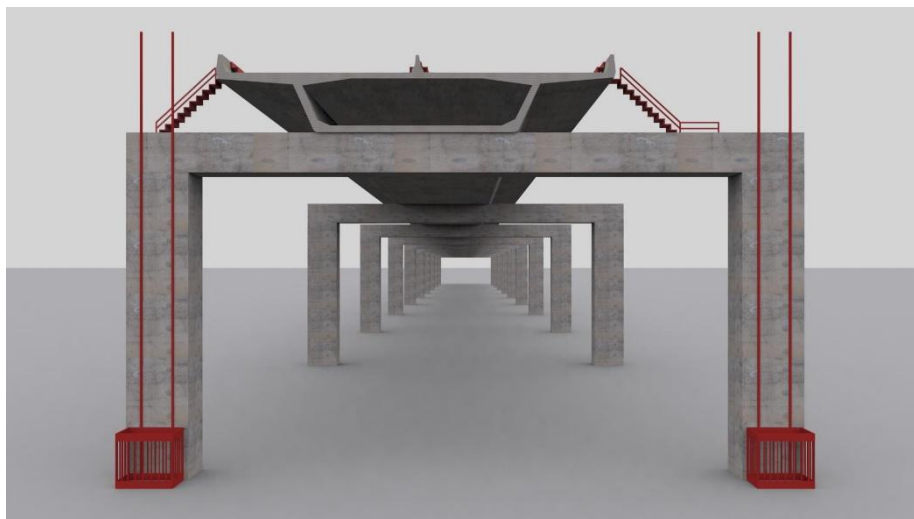
รูปที่ 2.5-18 ภาพจำลองแบบลิฟท์สำหรับอำนวยความสะดวกขึ้นทางยกระดับของโครงการ
